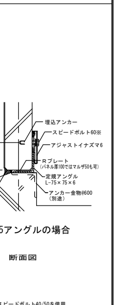
○ 梁下取付け部 (L-75アングルの場合)
